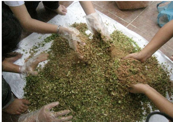
Hình 1.3. Hoạt động trộn hỗn hợp nguyên liệu CTR sinh hoạt và mặt cưa
