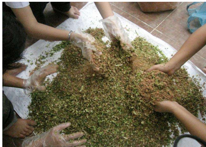
Hình 4.3. Hoạt động trộn hỗn hợp nguyên liệu CTR sinh hoạt và mặt cưa
